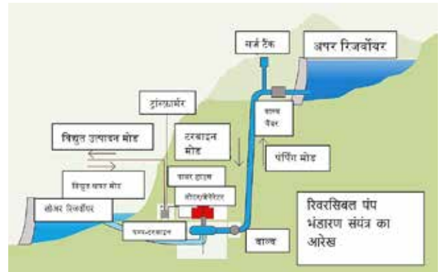
रिवरसिबल पम्प स्टोरेज हाइड्रो इलेक्ट्रिक पावर प्लांट का एक विशिष्ट लेआउट
