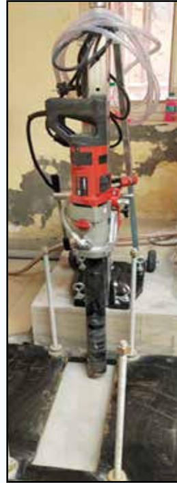
रॉक कोर ड्रिलिंग मशीन एवं ड्रिलिंग द्वारा निकाला गया बेलनाकार शिला कोर नमूना
