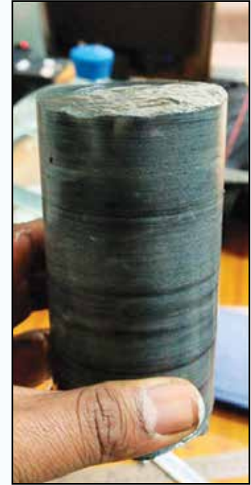
रॉक कोर ड्रिलिंग मशीन एवं ड्रिलिंग द्वारा निकाला गया बेलनाकार शिला कोर नमूना
